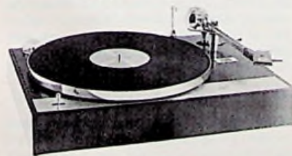
Stand 57 Eramatic 3 met elektronisch gestuurde arm. De sturing geschiedt d.m.v. een motor en foto-elektrische cellen.
